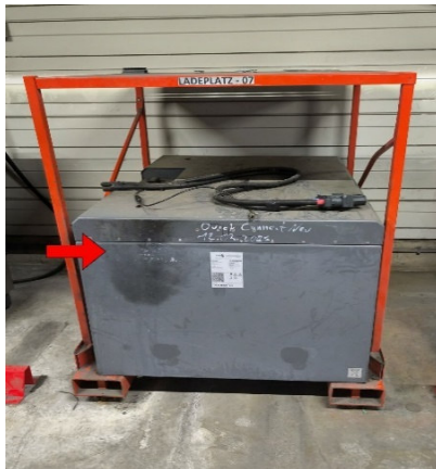
Foto 10_ Schmauchspuren durch entstandenen Kurzschluss an der Batterie
