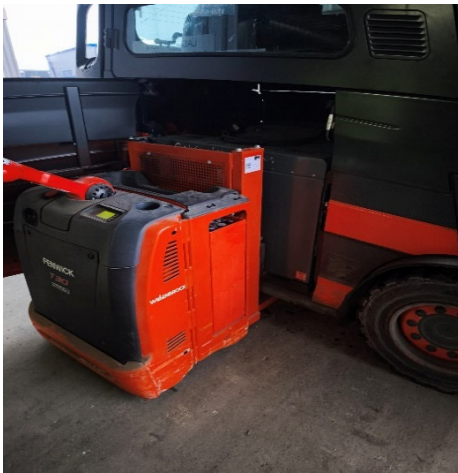
Foto 8_ Einsatz des Niederhubwagen beim Entnehmen des Lithium-Ionen-Batterie (2)
