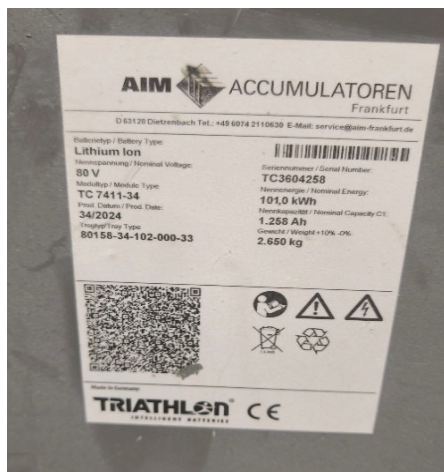
Foto 11_ Typenschild des beschädigten Lithium-Ionen-Batterie
