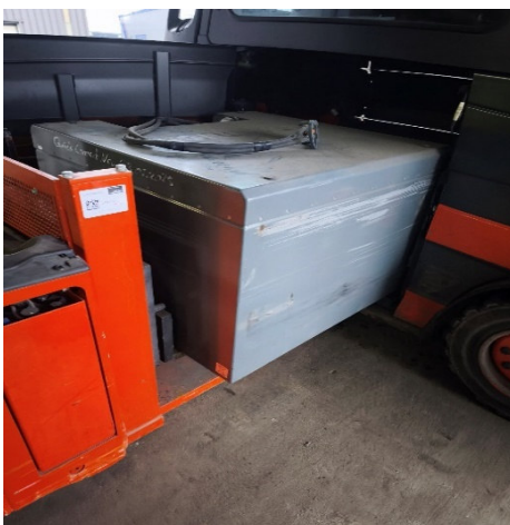
Foto 9_ Einsatz des Niederhubwagen beim Entnehmen des Lithium-Ionen-Batterie (3)
