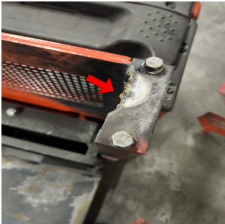
Foto 2_ Starke Schäden durch entstandenen Kurzschluß (2)
