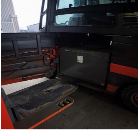
Foto 7_ Einsatz des Niederhubwagen beim Entnehmen des Lithium-Ionen-Batterie (1)
