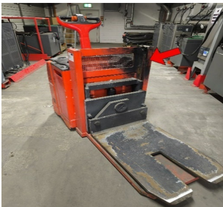
Foto 3_ Starke Schäden durch entstandenen Kurzschluß (3)
