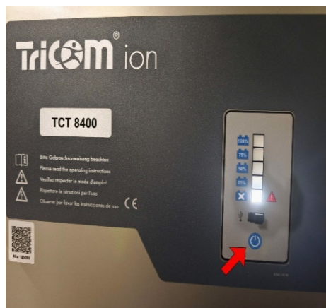
Foto 16_ Betätigung des Schalters am Ladegerät TCT 8400 nach Ladevorgang.
